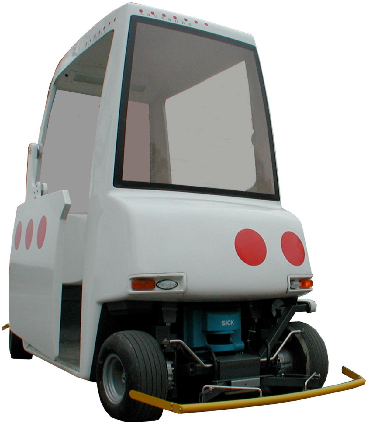
Serpentine est un petit véhicule électrique alimenté par induction à partir d'une voie active enfouie dans la chaussée, sans contact direct avec le véhicule.
